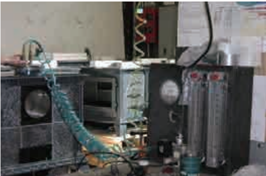
すべてのストーブはリークテスト（気密検査）が行われる
