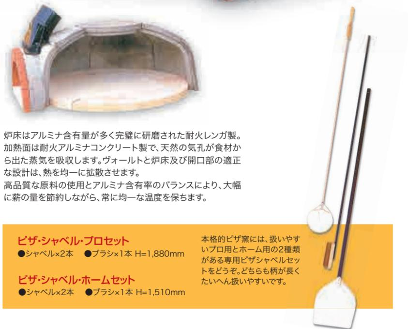
炉床はアルミナ含有量が多く完璧に研磨された耐火レンガ製。加熱面は耐火アルミナコンクリート製で、天然の気孔が食材から出た蒸気を吸収します。ヴォールトと炉床及び開口部の適正な設計は、熱を均一に拡散させます。高品質な原料の使用とアルミナ含有率のバランスにより、大幅に薪の量を節約しながら、常に均一な温度を保ちます。
