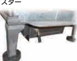
アジャスター:鉄製(空気層付)・直径100mm・高さ25mm・ボルト径3/8ボルト長さL=40
