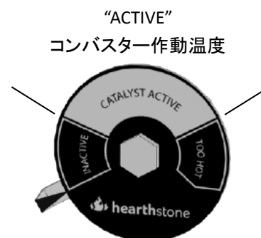
プローブ温度計が“TOO HOT”での継続燃焼は、コンバスターの損傷の原因となります
