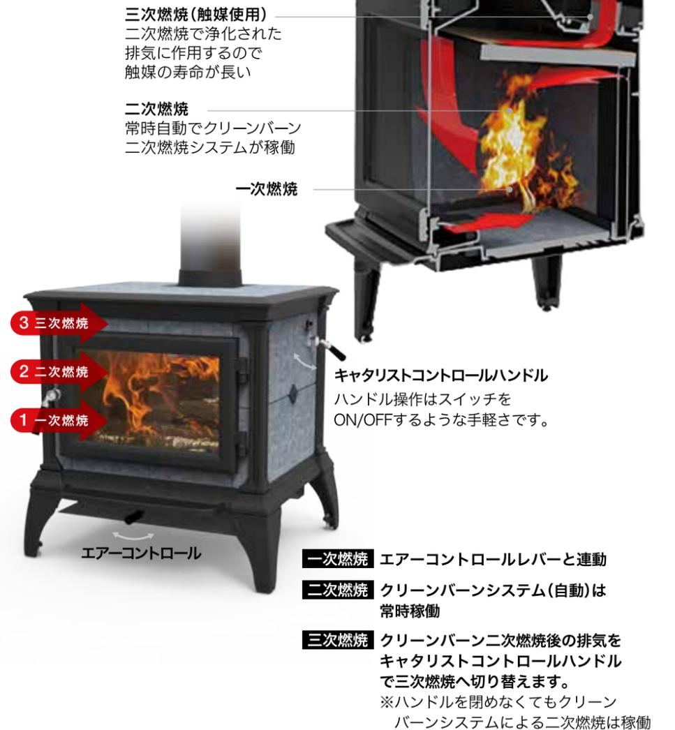
トゥルーハイブリッドシステムは、触媒を介さなくても、常時自動で二次燃焼クリーンバーンシステムが動いています。三次燃焼触媒モードへマニュアル操作で切り替えると、よりクリーンな排気と安定した巡回運転に移行します。
